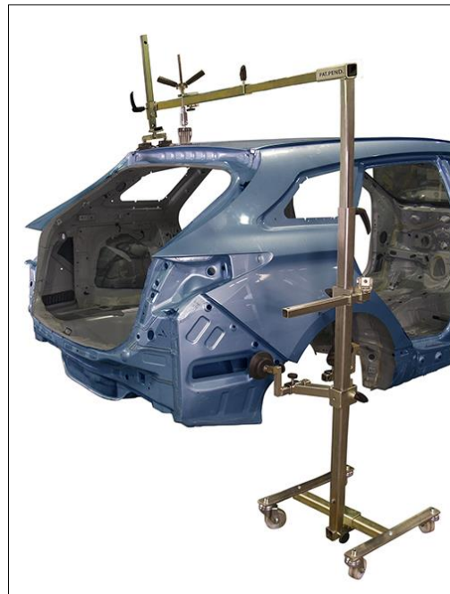
Richtvorgang an der Dachstruktur
