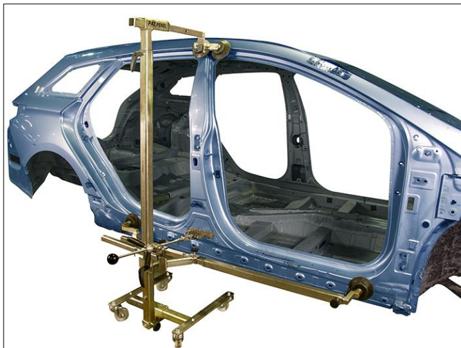
Richtvorgang am Seitenschweller
